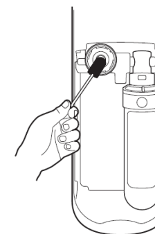
4. ทำความสะอาดข้อต่อตัวกรองกับแปรง
